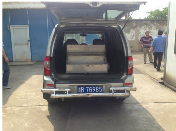
图 7-10 运输放射源使用的铅屏蔽箱
